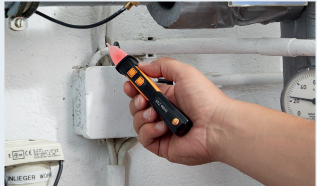
Erintésmentes feszültségmérés egy fűtőrendszer elosztódobozán a testo 745-tel.
