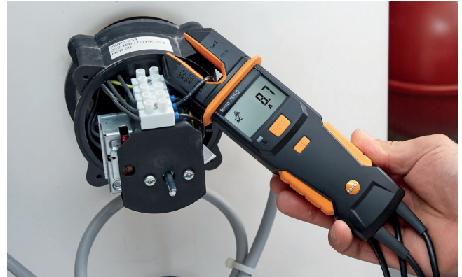
Automatikus mérési paraméterek felismerése, cserélhető mérőcsúcs és feszültségmérés 1000 V-ig.
